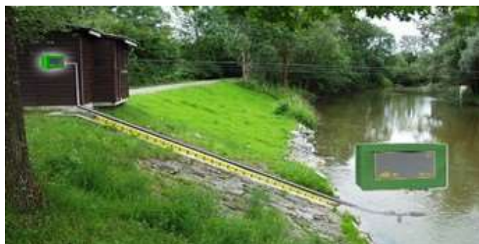
Montaj senzor de nivel cu bule de aer OTT CBS
