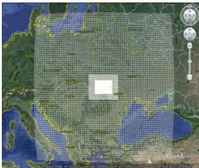
Trei domenii imbricate ale modelului WRF adaptat pentru bazinele hidrografice Prut și Siret din Ucraina.
