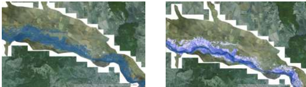
Hărți ale benzilor de inundabilitate corespunzătoare unor debite maxime cu probabilitatea de depășire de 1% și adâncimea apei aferente
